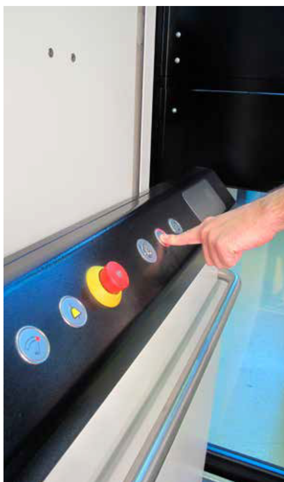
Dettaglio della pulsantiera e passamano di sicurezza
